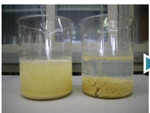
① パテ洗浄水10Lに対してNSクリーンを50gほど添加。1~2分間攪拌した後、約5分間静置する。
